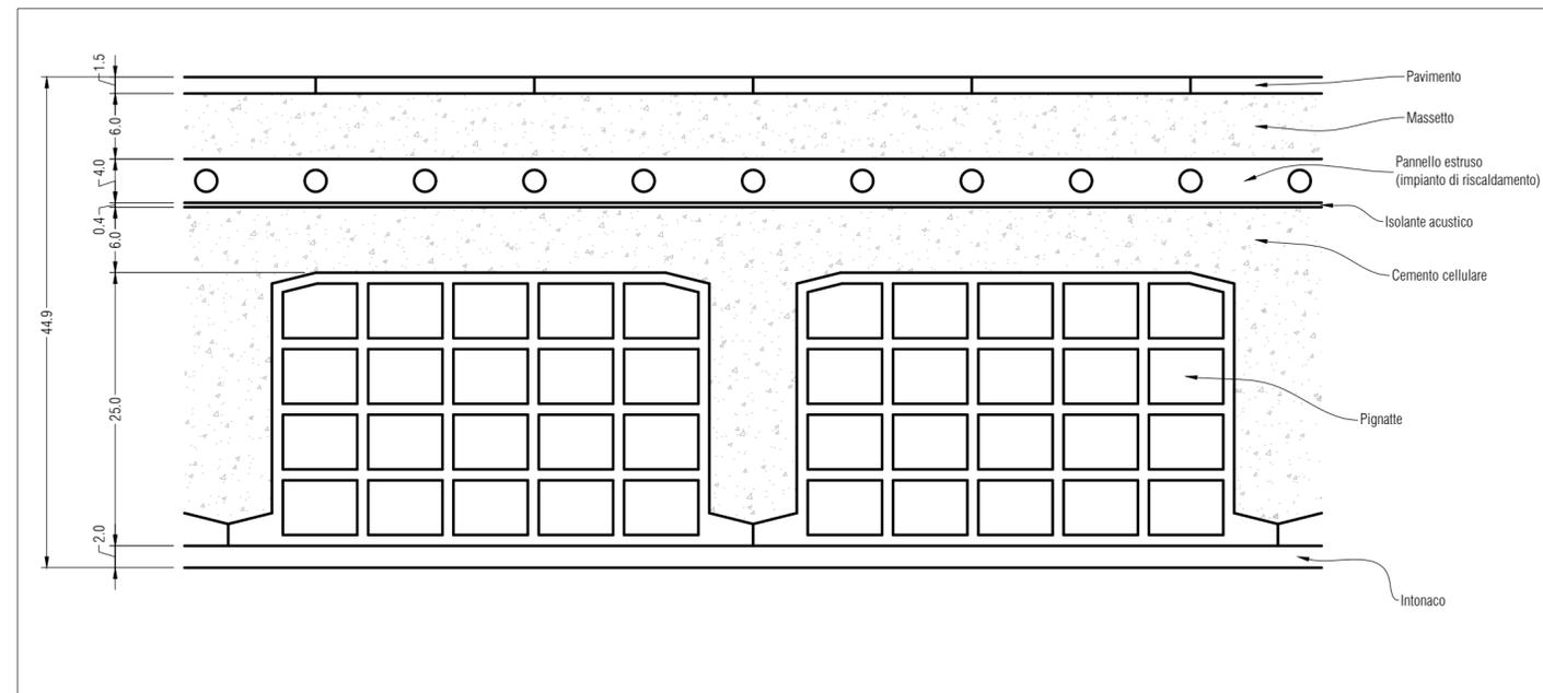
Sezione del solaio (1:5)
